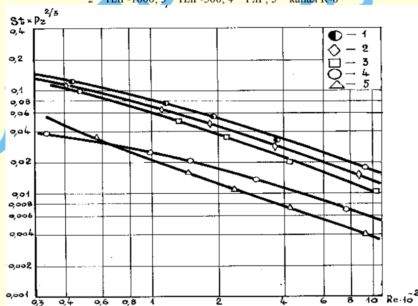
Рис. 1.321. Зависимость безразмерного комплекса St \cdot Pr^{2/3} – фактора Колборна от числа Рейнольдса при q_{\text{на}} = 8850 \text{ Вт/м}^2 : тип развитой поверхности: 1 – ПЛР-1000пр; 2 – ПЛР-1000; 3 – ПЛР-500; 4 – ГЛР; 5 – канал К-0
