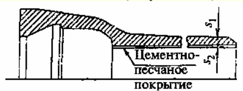
Рис. 3.1.6.8. Толщина стенки трубы, s_1 , и толщина цементно-песчаного покрытия, s_2
